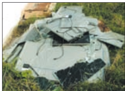
Totalverlust von Photovoltaikmodulen
