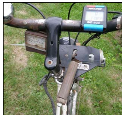
Bild 4: Schaltung durch Schaltkulissee 1. Gang, 2. Gang, Leerlauf
