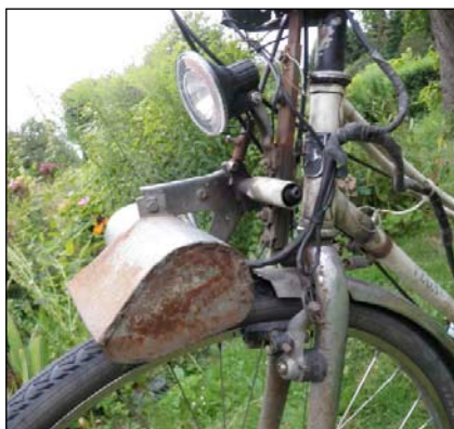
Bild 2 und 3: Gleichstrommotor mit verkleideter Reibrolle
