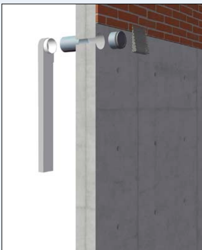
Bild 4: Mauerdurchführung für das Absaugset
