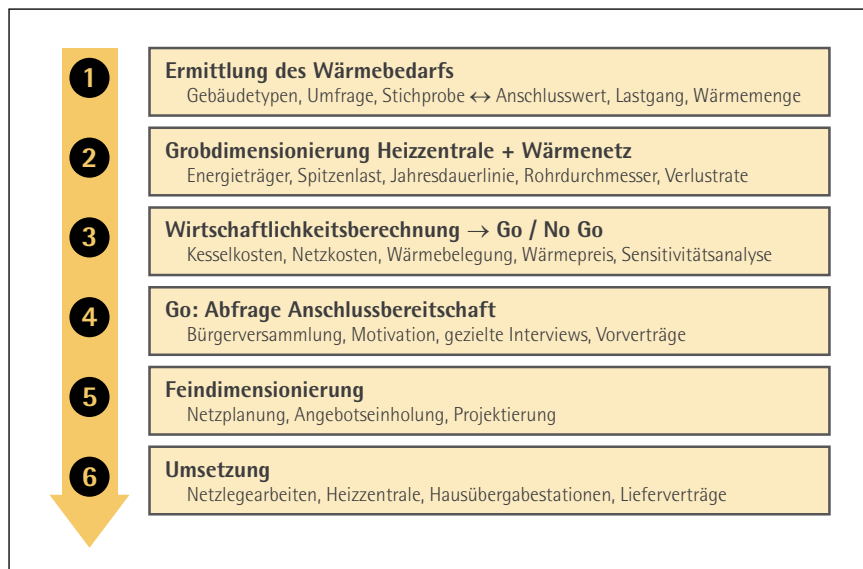
Bild 4: Vorgehen in sechs wichtigen Schritten von der Idee zu einem Nahwärmenetz
