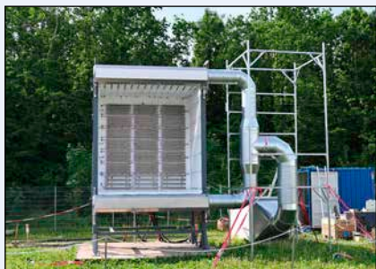
Bild 2: Experimenteller Nachbau eines solarthermischen Cavity-Receiver in Freiburg.
