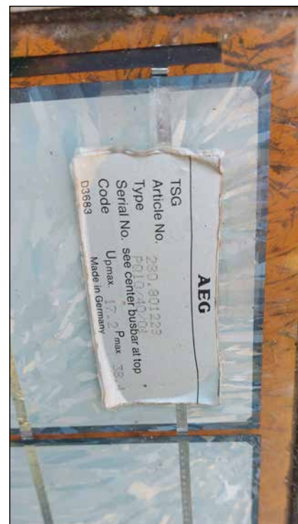
Bild 5: Nur auf wenigen Modulen waren die Etiketten noch lesbar. Die auf der Modulrückseite ursprünglich aufgeklebten Anschlussdosen hatten sich über die Jahre gelöst und hingen nur noch an den Kabeln.
