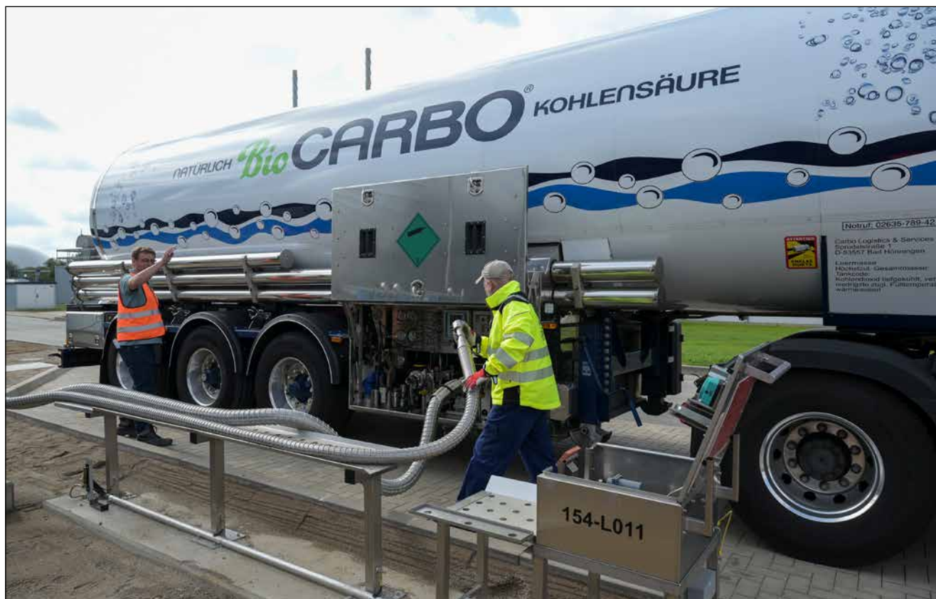
Bild 1: Abtransport des zuerst separierten und dann verflüssigten CO 2 zur Lebensmittelindustrie
