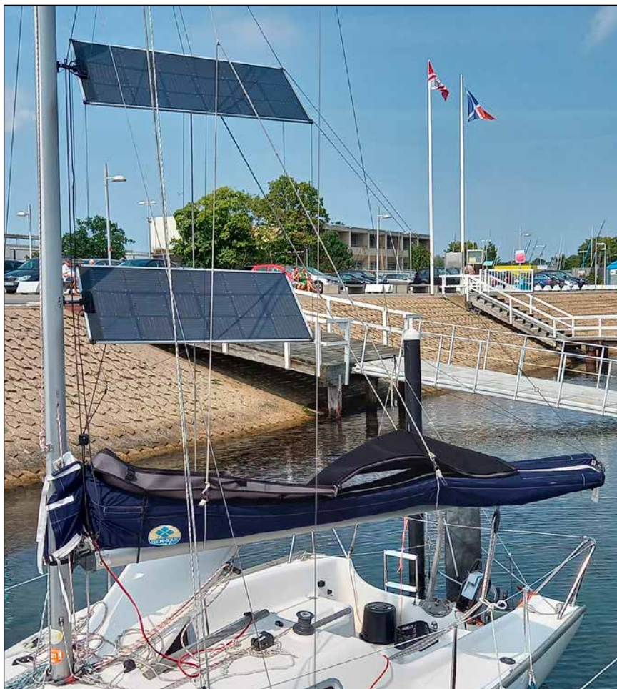
Bild 1: Mit spezieller Technik lassen sich leichte PV-Module an Bootsmasten hochziehen und liefern dann sowohl bei Flaute als auch im Hafen Strom. Ähnliche Konstruktionen sind auch für stabile Fahnenmasten denkbar. Gasquelle genutzt werden.
