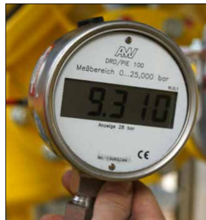
Bild 2: Dichtigkeitsprüfung vor der Inbetriebnahme des neuen Leitungsteils
