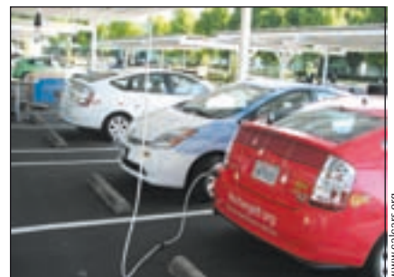
Die Überdachung des Firmenparkplatzes spendet nicht nur Schatten, sondern auch Solarstrom für die firmeneigene Versuchsflotte.
