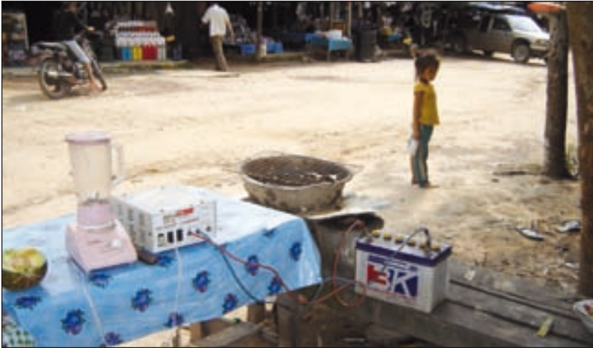
Abb. 6: Energieversorgung über solargeladene Batterien – Problemfall Energieeffizienz
