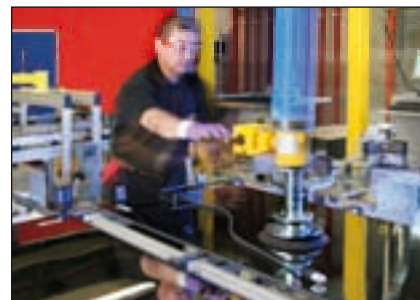
Bild 8: Endfertigung von CIS-Modulen bei WürthSolar [WürthSolar]
