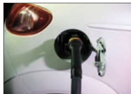
Die Schnellladesteckdose des R1e leitet die Energie über „armdicke“ Kabel mit 400 Volt Gleichstrom in wenigen Minuten direkt in die Lithium-Batteriemodule.
