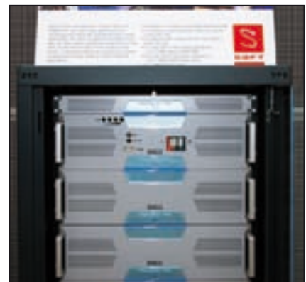
Lithium-Ionen-Schrank der Firma SAFT
