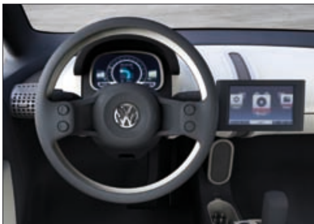
Das Amaturenbrett des Up! besteht nur noch aus zwei Flachbildschirmen. Die Anzeige soll sich auf das notwendige Minimum beschränken und dennoch alle Optionen offen lassen. Die Bedienung erfolgt durch Berührung und Fingergesten.
