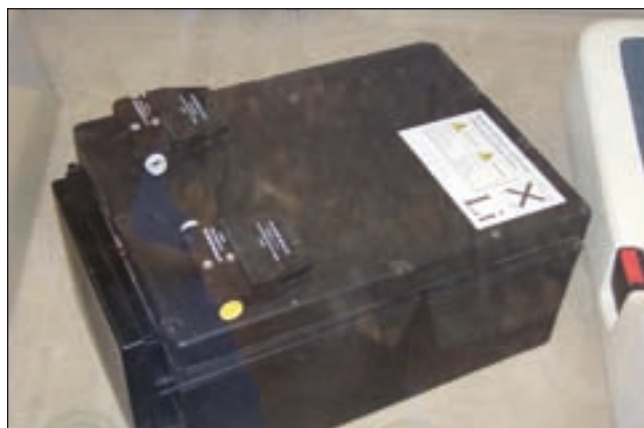
Zehn dieser Lithium-Metall-Polymer-Batteriemodule der Firma BatScap sind im Fahrzeug verbaut und können 28 kWh Strom speichern. Damit soll das BlueCar rund 250 km zurücklegen können.
