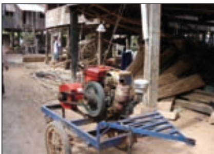
Bild 2: Dieselgenerator in Kambodscha
