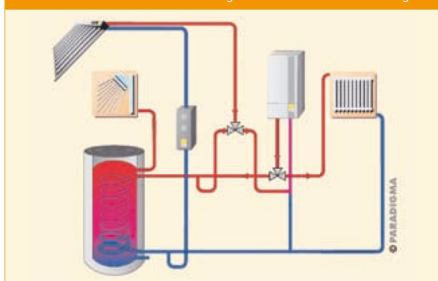
Bild 8: Verschaltungsschema des Aqua-Systems für kombinierte Trinkwassererwärmung und Raumwärmeunterstützung
