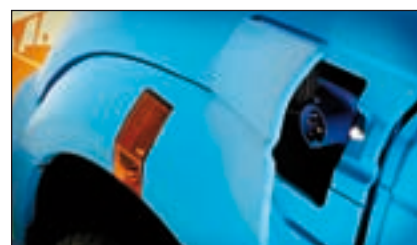
Der „Tankstutzen“ sitzt im linken Kotflügel und basiert auf einer normalen CEE-Steckdose.
