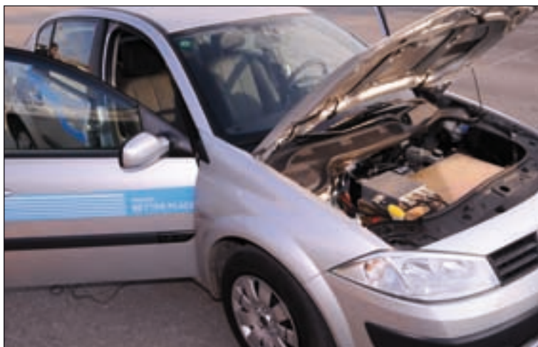
Das erste Testfahrzeug von Project Better Place ist ein Renault Megane. Die Antriebstechnik mit Netzurückspeisung stammt derzeit offenbar noch vom kalifornischen Elektroautohersteller AC-Propulsion.
