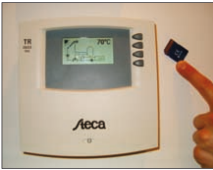
Bild 4: vorgestellt: Solarregler mit Speicherung auf SD-Karte (Fa. Steca)
