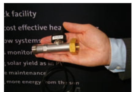
Bild 3: vorgestellt: Volumenstrommessung ohne bewegliche Teile (Fa. Grundfos)
