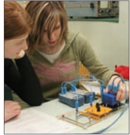
Bild 5: Experimentieraufbau zur Ermittlung der Kennlinie einer Solarzelle. Die Solarzelle ist in Reihe geschaltet mit einem veränderlichen Widerstand und wird mit dem leXsolar-Beleuchtungsmodul beleuchtet.
