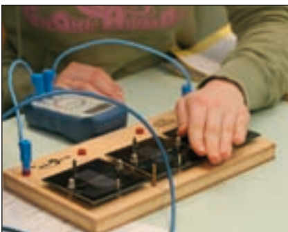
Bild 4: Ein Solarmodul mit Teilverschattung: Drei Solarzellen in Reihe geschaltet, von denen eine verschattet wird.
