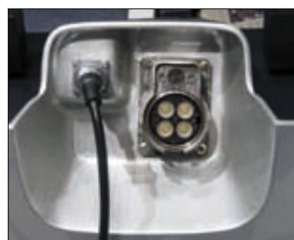
Für den Netzanschluss plant man bei BYD neben dem normalen 230-Volt-Kabel (2,3 kW) auch eine Buchse für Schnelllade-Strömankstellen. Die von ODU hergestellte Verbindung kann neben Daten auch bis zu 60 kW elektrische Leistung übertragen.
