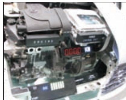
Im Elektro-Hybriden F3 DM stecken zwei Motoren. Neben dem 50 kW starken elektrischen Hauptantrieb liegt links der 50 kW starke Verbrennungsmotor. Auf der Autobahn können beide auch mechanisch gekoppelt werden, womit man 100 kW Dauerleistung abrufen könnte.
