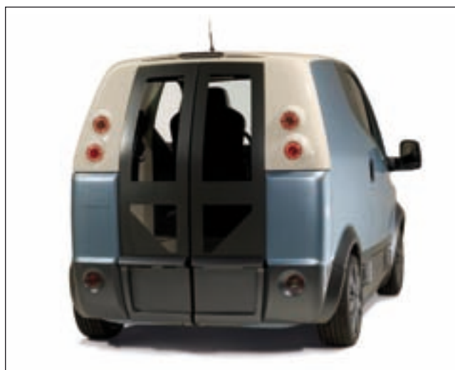
Bild 3: Das Heck ist geprägt von der zweiteiligen Innenschwenktür, durch die man auch in sehr beengten Parksituationen gut in den Laderaum gelangen kann.
