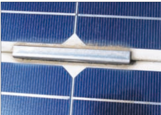
Bild 2: Verschmutzung von Modulen (nach 10 Jahren Anlagenbetrieb)
