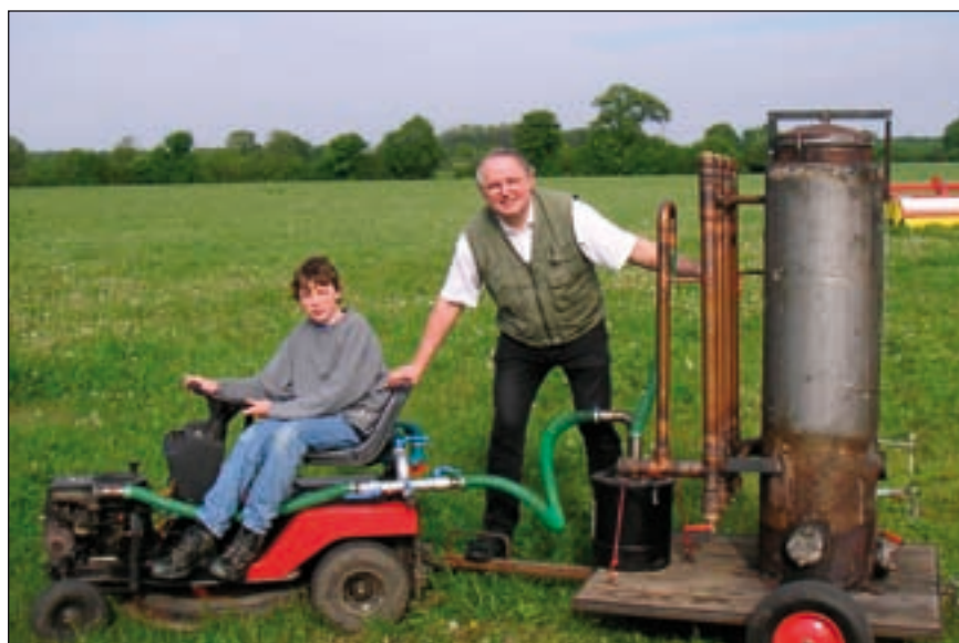
Fortbewegung auch ohne Biokraftstoffe mittels effizienter Holzgastechnik
