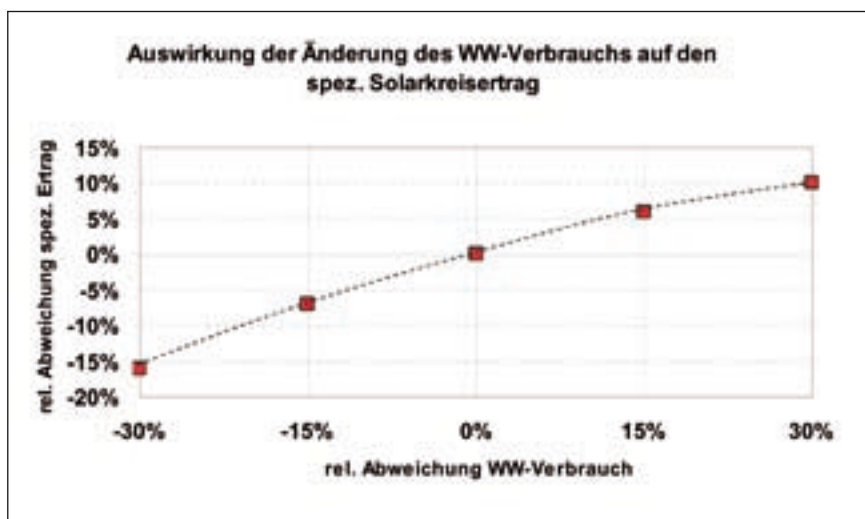
Bild 2: Der spezifische Solarkreisenertrag in Abhängigkeit vom WarmwasserVerbrauch
