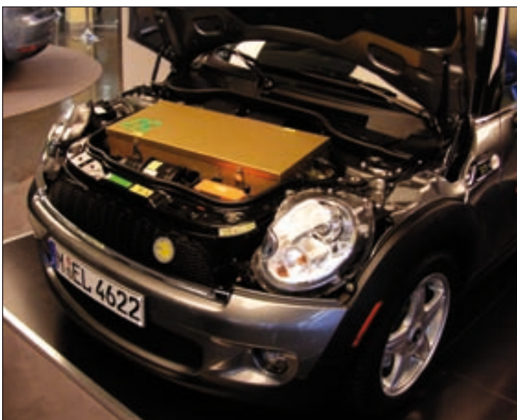
Bild 2: Im britischen Mini Cooper steckt die Antriebseinheit des kalifornischen Herstellers AC Propulsion und rund 5.000 japanische Lithium-Zellen, die mit dem Strom eines schwedischen Konzerns betankt werden sollen. Ein typisch deutsches Projekt?
