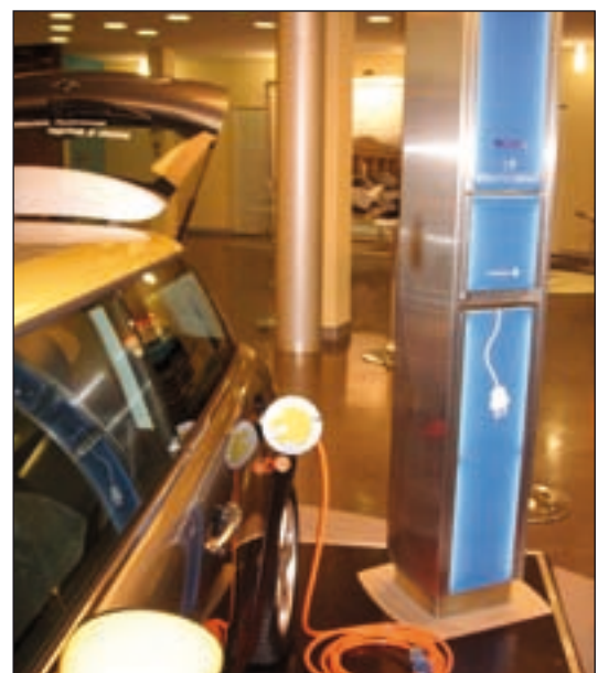
Bild 3: Zum Anschluss an die Vattenfall-„Werbesäule mit Steckdosen-Option“ sorgt ein daumendickes, sieben Meter langes Kabel in Baustellenqualität. Hier sind „echte Männer“ gefragt.
