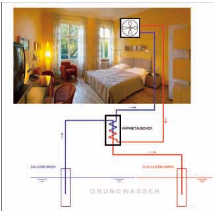
Das Funktionsschema der Grundwasserkühlung
