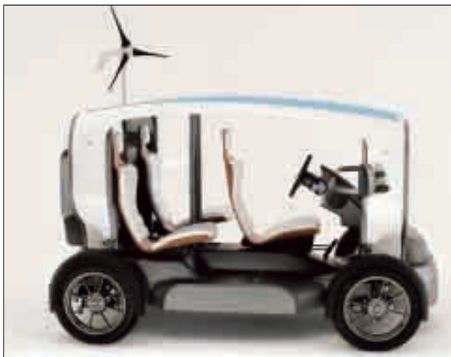
Bild 1: Der Venturi Eclectic hat neben einem Dach aus Solarzellen auch ein optionales Mikrowindrad.
