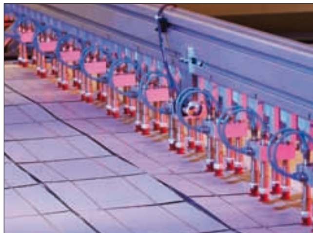
Zellenstrings werden automatisch vor der Laminierung abgesetzt.
