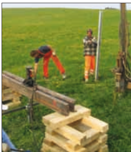
Bild 5: Projektspezifische Probelastung eines Kleinpfehlelementes
