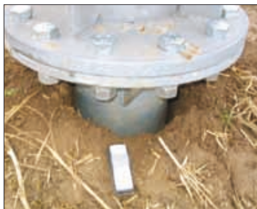
Bild 8: Beispiel für einen massiven Schadensfall an einer PV-Freiflächen-Pfahlgründung im wassergesättigten, bindigen Frühjahrsboden nach Durchzug eines Orkanes [nachführbare Anlage, Panels und Montagesystem nach dem Schaden wieder demontiert; Bilder unveröffentlicht]
