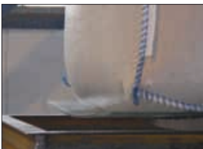
Bild 4: tonnenschwere Belastung auf ein verklebtes Photovoltaikmodul
