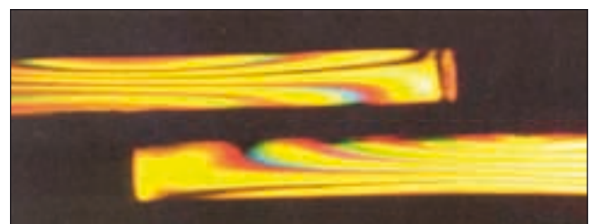
Bild 2: elastische Verklebung – Lasteinleitung über die Vollfläche
