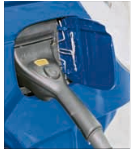
Bild 2: Die Ladeklappe des Sprinter PHEV
