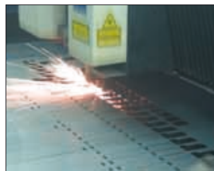
Neben Handarbeit wird auch modernste Produktionstechnik eingesetzt (hier: Laserschneiden)
