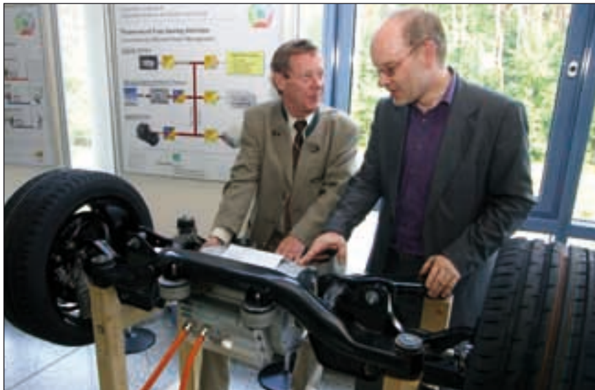
Fraunhofer-IISB mit eigener Solaranlage und Solartankstelle: Hier eine Hinterachse aus einem Audi TT, in den die Erlanger Forscher anstelle des Differenzials einen kompletten Elektroantrieb mit zwei Motoren eingebaut haben. Dahinter: bisheriger FHG-Institutsleiter Prof. Heiner Ryssel (links) und Arbeitsgruppenleiter Dr. Martin März
