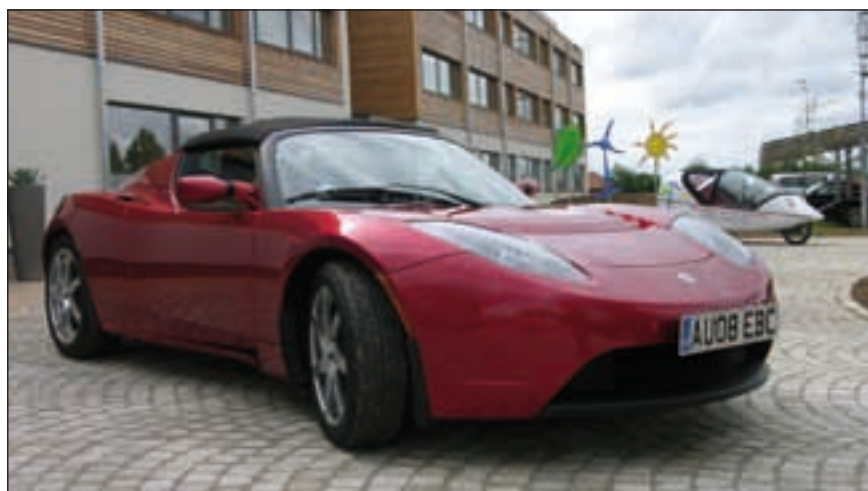
Bild 1: Der Tesla Roadster ist ein klassischer Sportwagen, jedoch mit einem 100% elektrischen Antrieb, der seine Energie aus handelsüblichen Laptop-Batteriezellen bezieht. Im Jahr 2006 wurden die ersten Fahrzeuge verkauft und seit 2008 ist dieses Modell auch in Europa für knapp 120.000 Euro käuflich zu erwerben.
