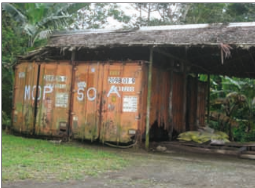
Besonderheiten der Klimatischen Bedingungen: Korrosionsprobleme von Seecontainern auf Papua Neu Guinea
