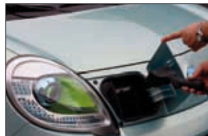
Bild 3: Renault geht bei den neuen Modellen den einzig korrekten Weg und platziert den Ladeanschluss vorne.
