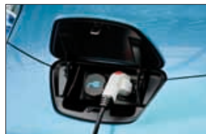
Bild 4: Auch Nissan hat die Anschlüsse für die Stromzuführung beim LEAF vorne unter dem Logo positioniert. Es gibt eine Buchse für das normale Wechselstromnetz und eine für Gleichstromschnellladung.
