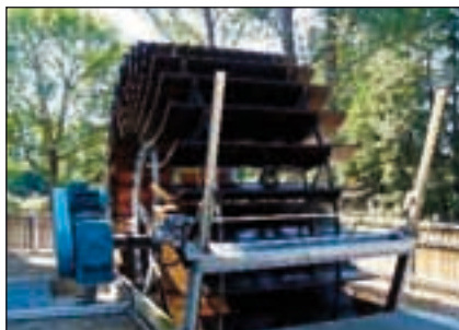
Altbewährtes Wasserrad (links) und ein neuer Ansatz zur Nutzung der Flusswasserkraft (rechts). Links: „Zuppinger Wasserrad“ aus dem 19. Jahrhundert bei Ulm (Quelle: Mühlbauer 2006). Rechts: Transport der Stromboje bei Wachau (Österreich). Quelle: Aqua Libre Energieentwicklungs GmbH (2007)
