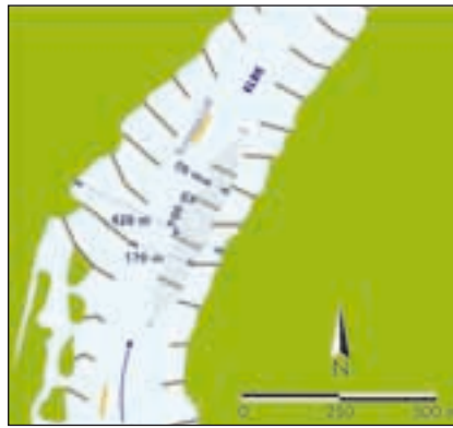
Installationsbeispiel an der Elbe bei Havelberg (4 Segmentreihen à 7 Segmente)
