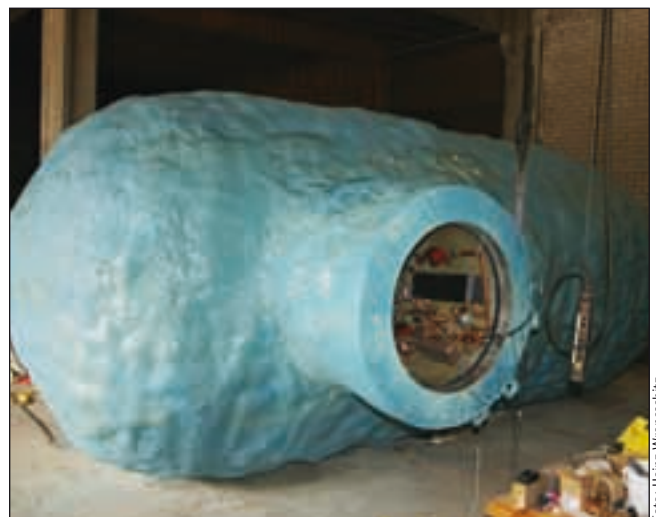
Nur drei Doppelrohre führen aus dem Ebitsch-Schichtenspeicher (hier der Prototyp um 90 Grad gedreht) heraus: Ingenieur Viktor Schäfer ist ein technischer Geniestreich gelungen (links). Um 90 Grad gedreht wirkt der Prototyp fast wie ein U-Boot (rechts)
