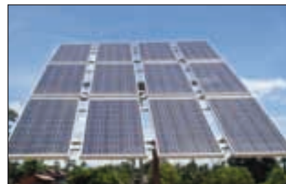
Bild 3: ein kambodschanisches, mechanisch funktionierendes solares Nachführsystem
