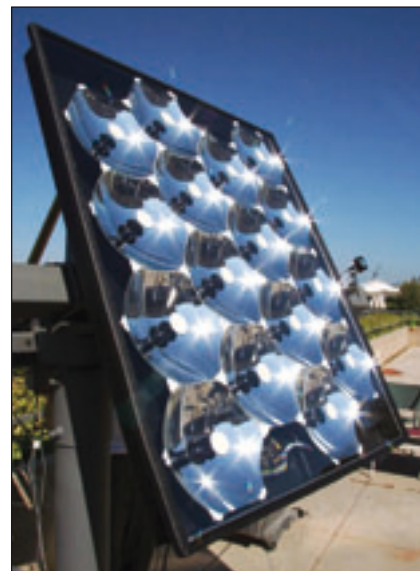
Bild 6: Modulares (low-cost) Cassegrain Kollektorsystem der Firma SolFocus. Im Brennpunkt der Kollektoren befinden sich spezielle Multiple-Junction Solarzellen.
