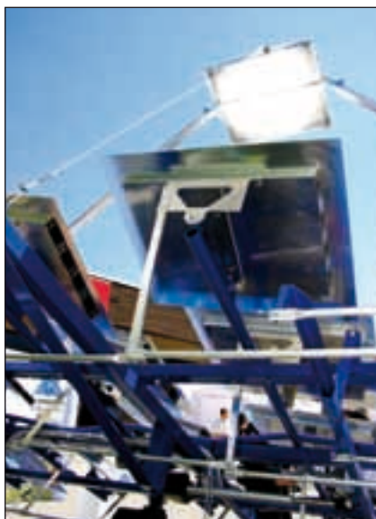
Bild 2: 24 Spiegel werden nach einer Linearfunktion auf den oben befindlichen Absorber ausgerichtet.
