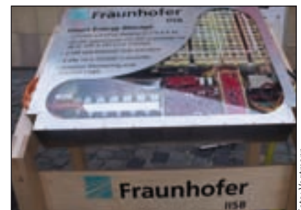
Smart Grid Vehicle Akku mit 2.2 kWh Kapazität
