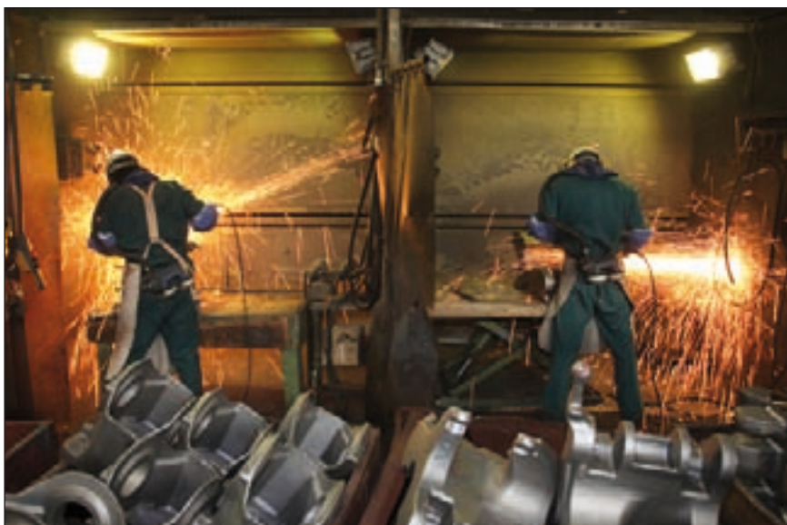
OGOWIN – Stahlgießerei Friedrich-Wilhelms-Hütte Mühlheim. Das Putzen der Stahlgussoberflächen wird von den Arbeitern noch von Hand ausgeführt
