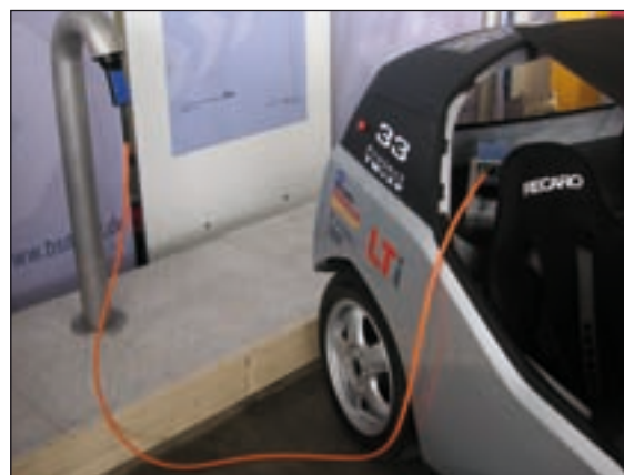
Bild 5: Die unaufdringliche und extrem kostengünstige Stromstelle wird erst durch den neuartigen Ladestecker möglich. Im Fahrzeug kann man das blaue Babelbee-Modul erkennen, welches den dynamischen Ladevorgang regelt.
