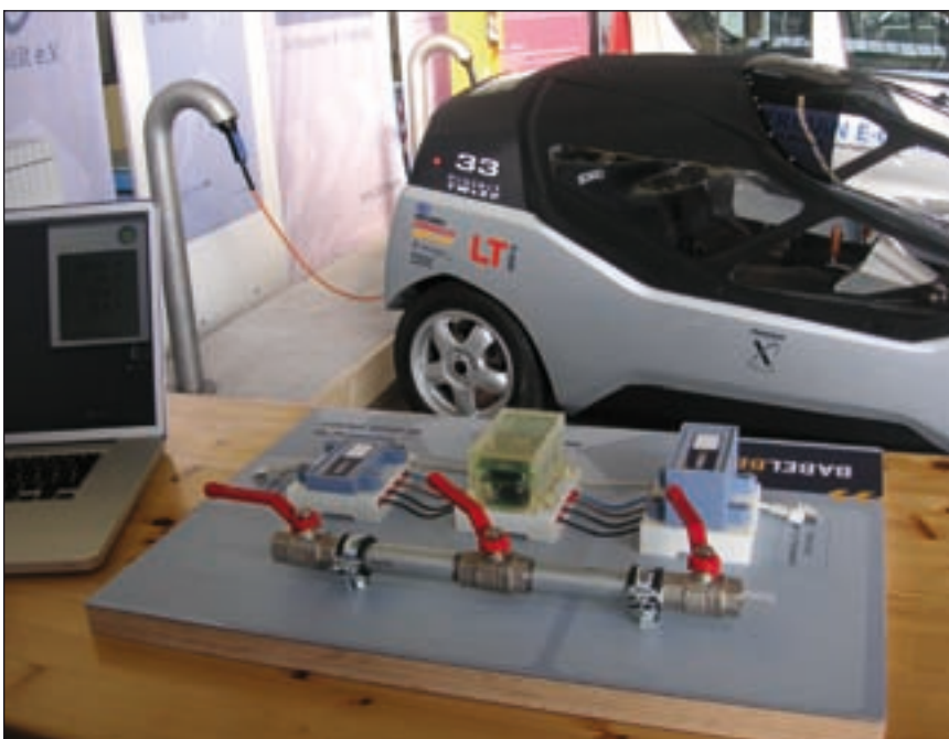
Bild 6: Das Babelbee-System versucht das Funktionsprinzip von Wasserhähnen auf das Stromnetz und damit das Lademanagement von Elektroautos zu übertragen.
