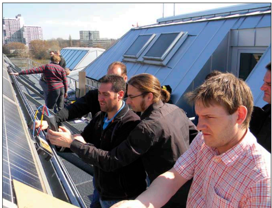
Bild 3: Theorie und Praxis der Kennlinienmessung
