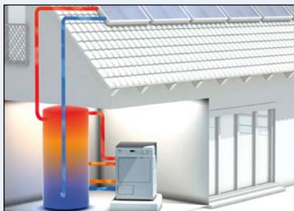
Bild 3: Solartrockner mit Schichtenspeicher und Solarthermie
