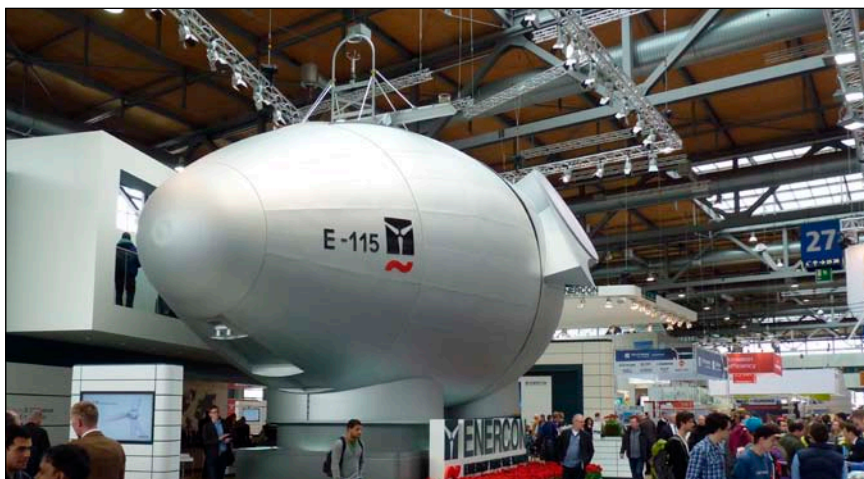
Bild 1: Die Gondel einer Enercon-2,5 MW-Windkraftanlage. Für den dazugehörigen Rotor mit 115 m Durchmesser fehlt schlicht der Platz in der Messehalle.
